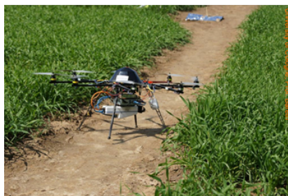
9. ábra. Első mini hiperspektrális kamera multikopterén (Fotó: Bareth, 2013)
