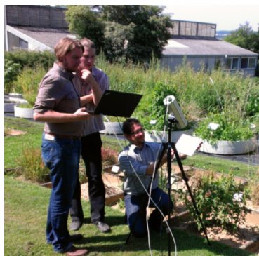
10. ábra. Hiperspektrális „snap-shot” kamera terepi alkalmazásban (Fotó: szerző felvétele, Hohenheimi Egyetem, 2013)
