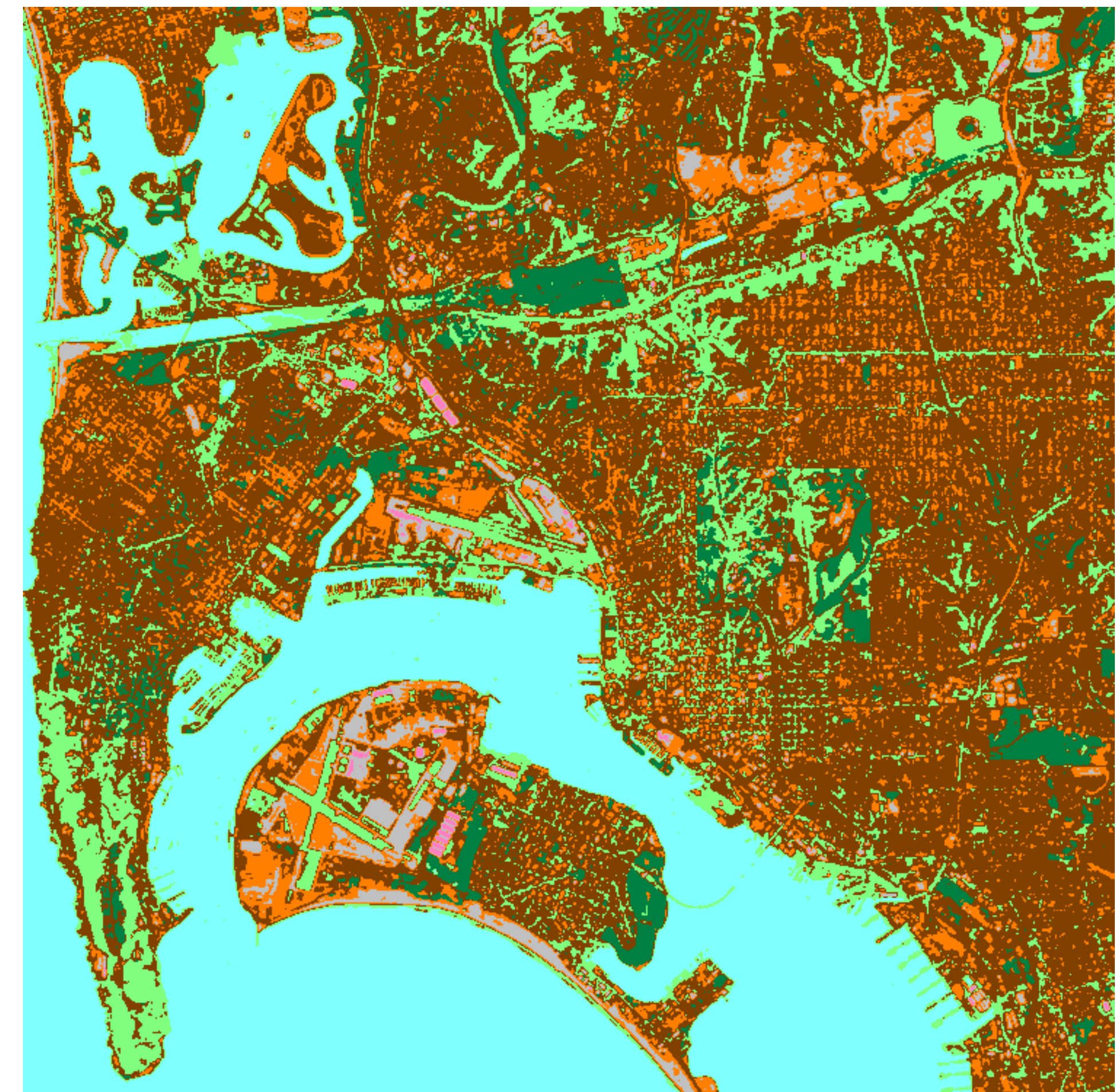
2. ábra. SPOT úrfelvétel és az ISODATA eljárás eredményeként kapott klaszterezés.
